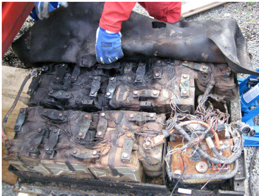
HV boksen er nærmest i høyre hjørne, original BMS rett bakenfor. Ny BMS ligger i en sammensunket plastboks i tomrommet. Bildet er altså tatt forfra (i forhold til kjøreretning)
