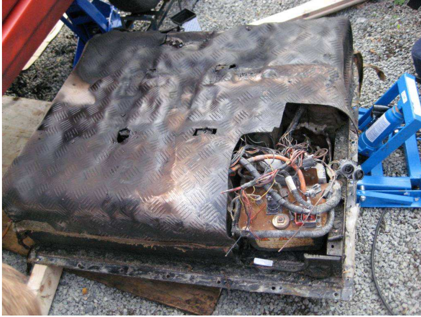
En stor gummimatte var plassert over cellene som elektrisk isolasjon og som mekanisk beskyttelse. Det fungerte også som termisk isolasjon
