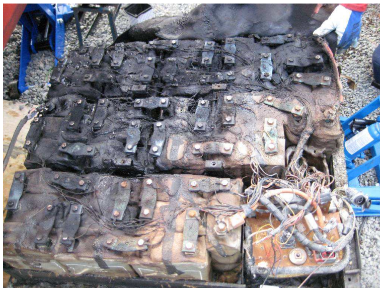
Her ser en tydelig at overopphetingen er proporsjonal med avstanden fra hjørnet under serviceluka.
