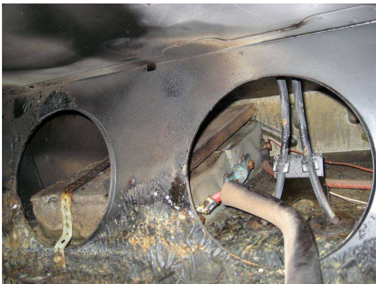
De 2 cellene i rommet bak batterikassa. Kabelen som går ned i høyre del av bildet er den samme som på forrige bilde, den har ligget tett opp mot taket, se det lysebrune feltet i taket.
