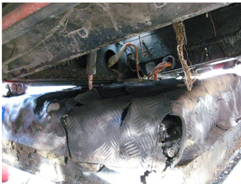
Høyre bakre hjørne, idet kassa senkes. En ser kabelen som går til cellene i bakrommet litt til venstre for midten av bildet.
