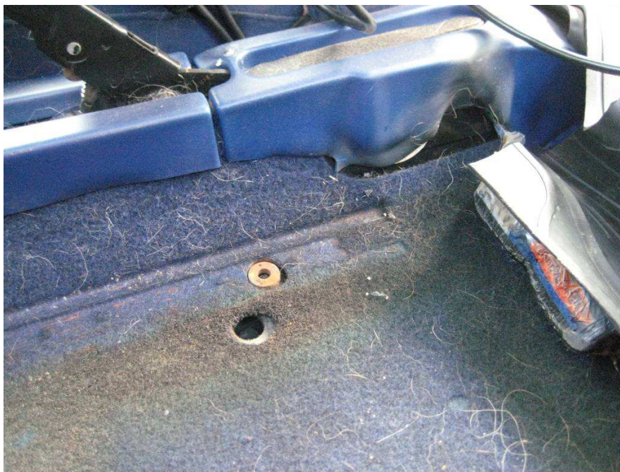
Inne i bilen var det tydelige spor etter sterk varmeutvikling. Håndbrekket er øverst til venstre, setet er her fjernet.
