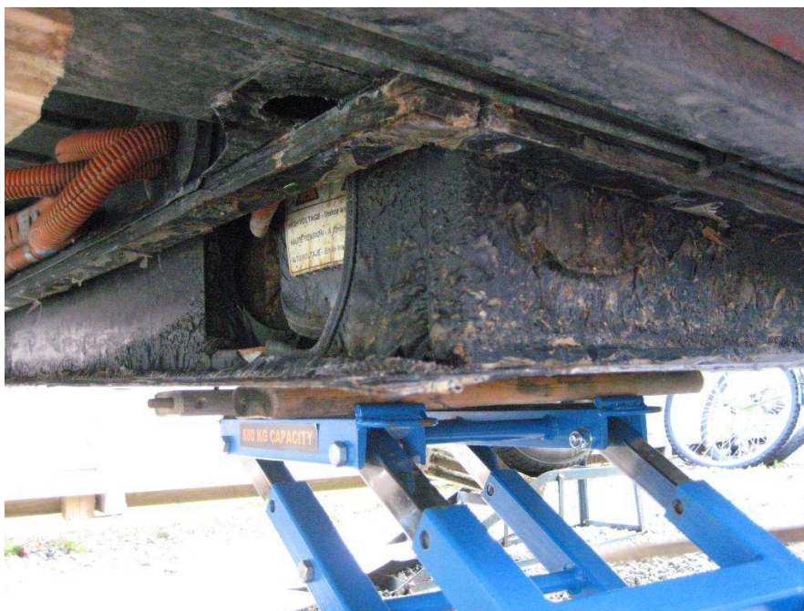
Fremre venstre hjørne, legg merke til at lakken på kassa har løsnet.
