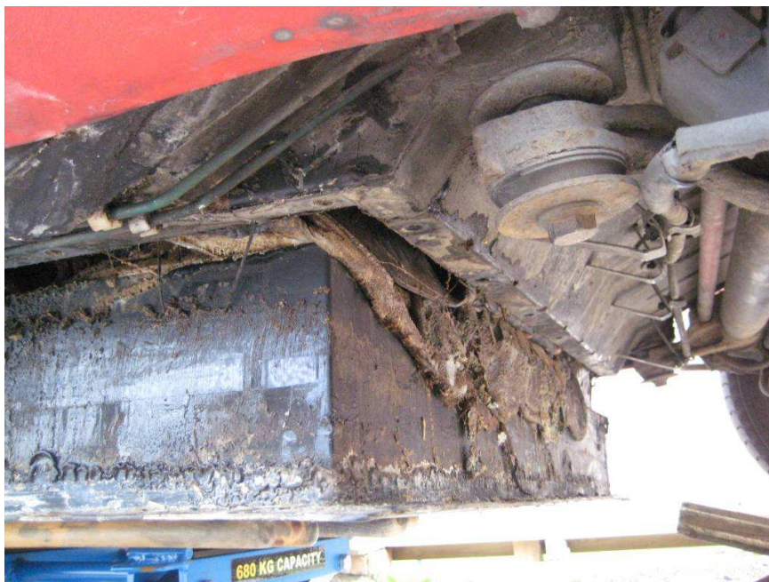
Bakre venstre hjørne. Det er smeltet plast som henger ned utenpå kassa. Det som henger utenpå nærmeste hjørne er rester etter en lerretstape.
