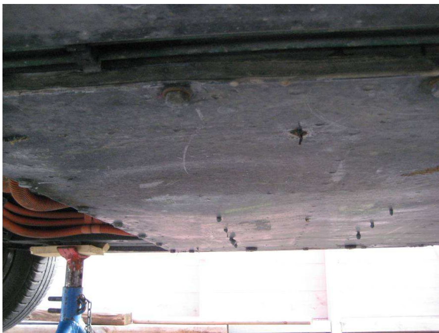
Under bilen kunne vi se tråder av smeltet plast.
